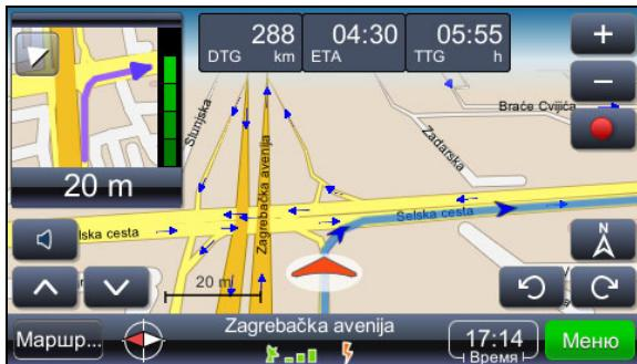
Указание на ближайший поворот отображается в левом верхнем углу экрана. Чтобы скрыть окно, коснитесь пером треугольника в левом верхнем углу.
