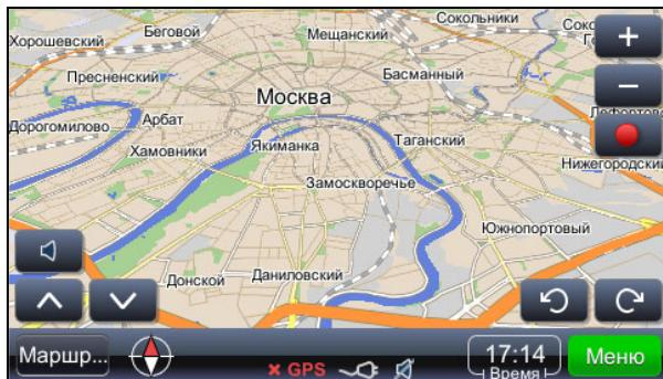
Текущее местоположение определяется с помощью сигнала GPS. Зеленый цвет значка означает наличие сигнала.
